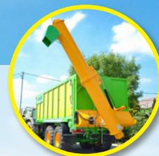
Tornillo para granos con gran caudal - 7 500 kg/min - versión específica para el ensilado - 12 m<sup>3</sup>/min
